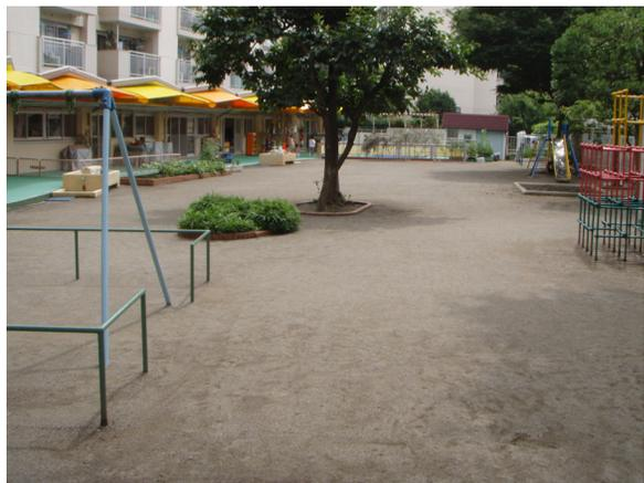
ヨツヤウレタンは三月中旬に受注した表題工事を三月二十五日に完工した。当工事は在来のクレー舗装を四十㎝掘起し、そこに針葉樹皮土壌改良土を加え混合させて転圧舗装した工事であった。戸山第三、戸山第一の両園庭を改修舗装した工事でした。短い工期だったので天候変化に気遣いながらの現場でありました。
